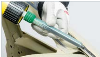
Łatwa aplikacja za pomocą miksera statycznego
