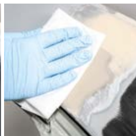
Czas odparowywania 5 min. przed lakierowaniem
