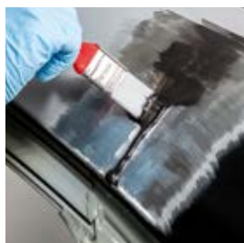
Dyfuzyjna warstwa ochronna uzyskana dzięki TEROSON EP 5055
