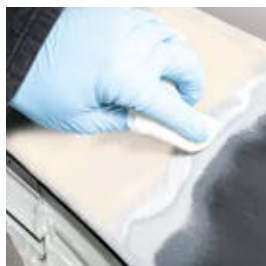
Aplikacja BONDERITE M-NT 1455 W tylko na goły metal. Zwilżenie przez 2 min.
